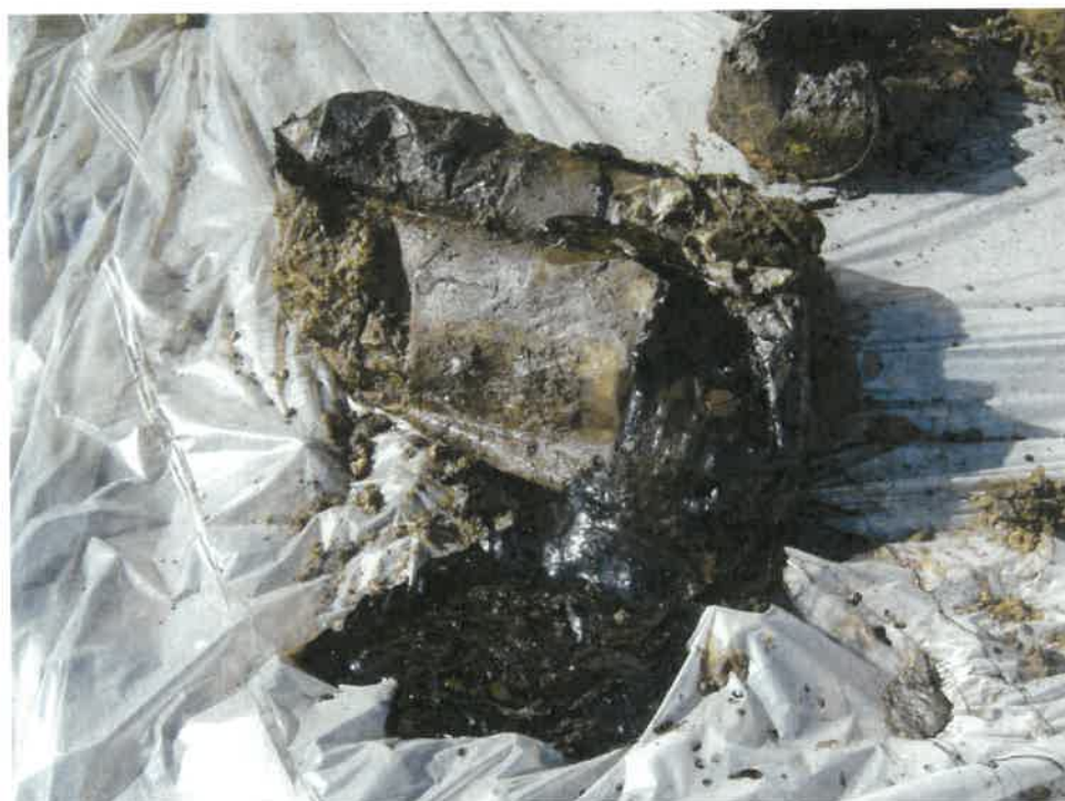
Photographie 27 : autre exemple de fût métallique percé avec suintement de produits
