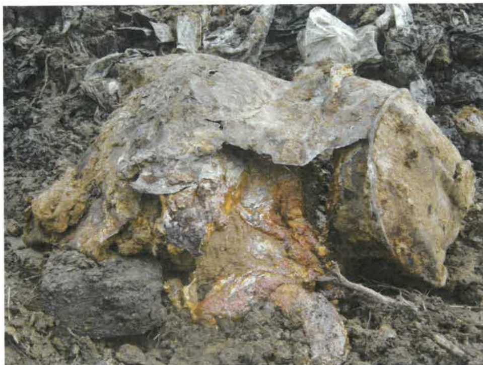
Photographie 26 : fût métallique percé avec suintement de produits
